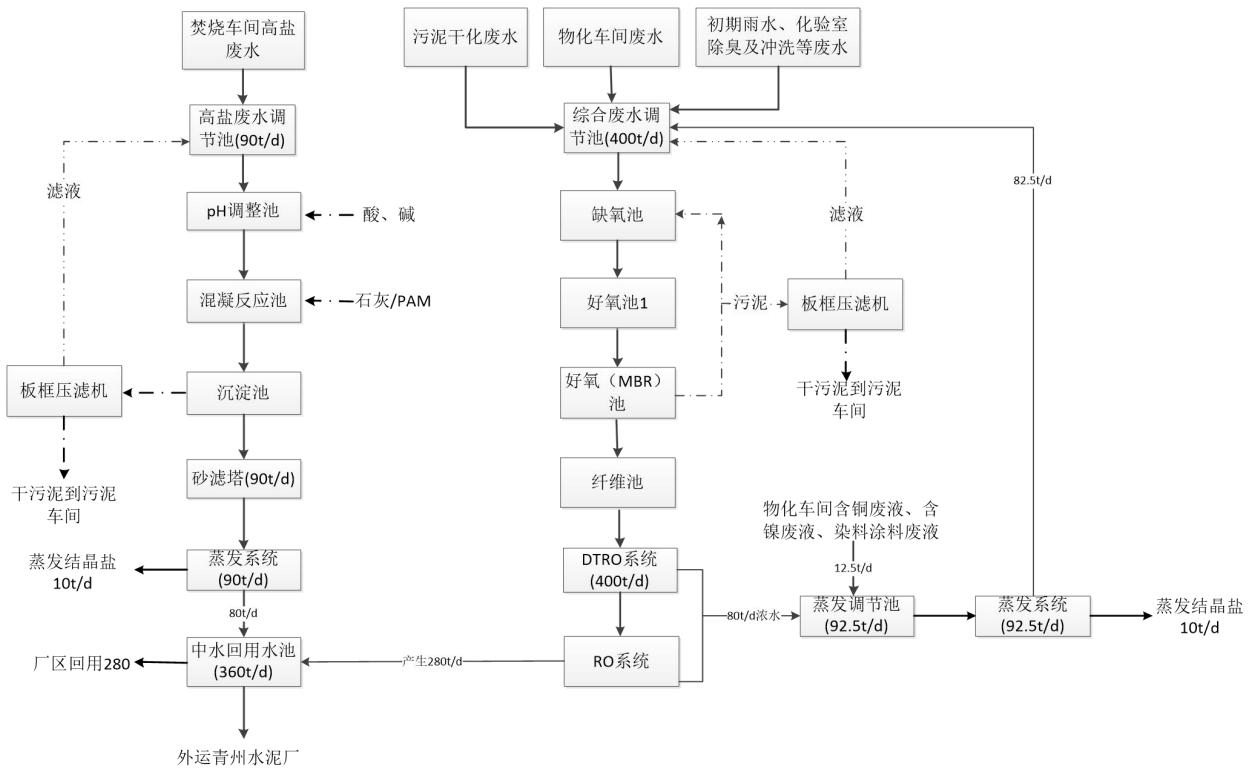
图2.1-15 废水处理工艺流程图
