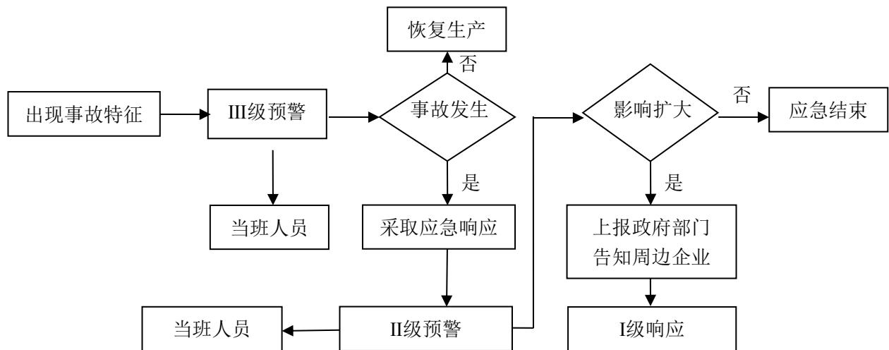
图 4.2-1 预警信息发布流程图
