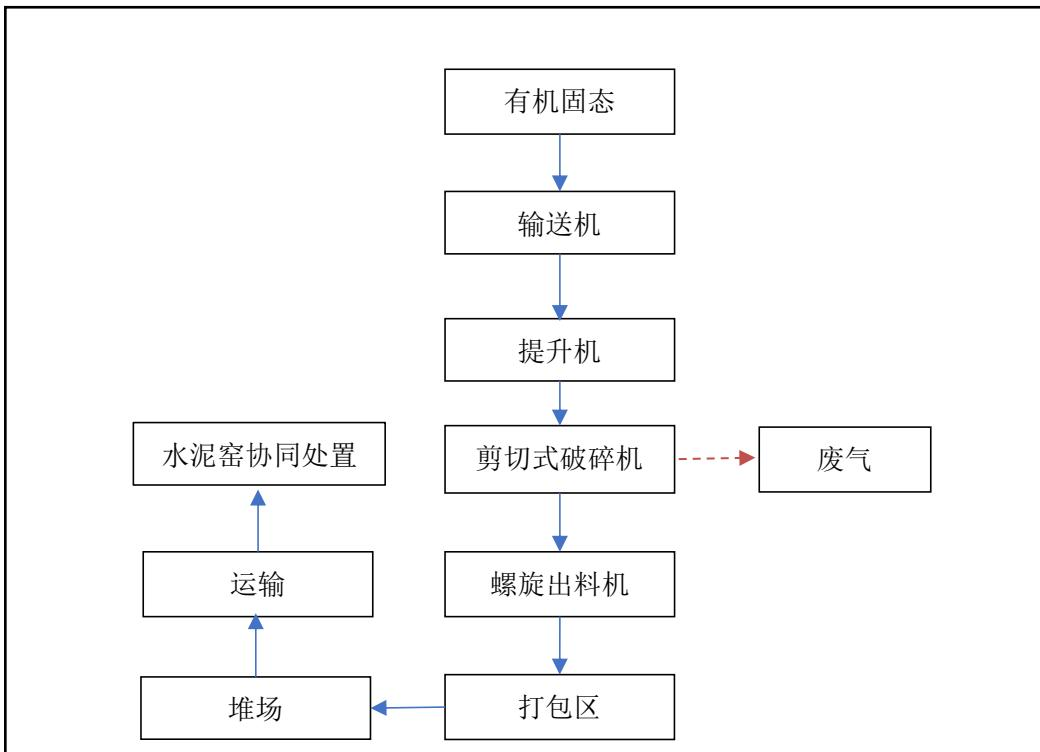
图 2.1-11 有机固态危险废物预处理工艺流程及产污环节图
