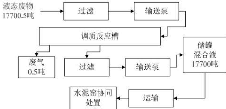
图 2.1-12 液态危险废物预处理工艺流程及产污环节图
