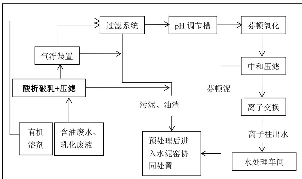
图 2.1-7 有机溶剂、含油废水、乳化废液处理工艺流程及产污环节图
